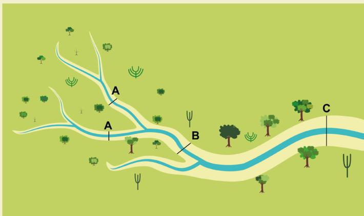
Figura 3. Os pontos A, B e C correspondem aos locais indicados para implantação da barragem subterrânea. Os locais indicados nos pontos A, são desfavoráveis, enquanto o ponto B corresponde a um local intermediário, e o ponto C o mais indicado. Adaptado de [16].
